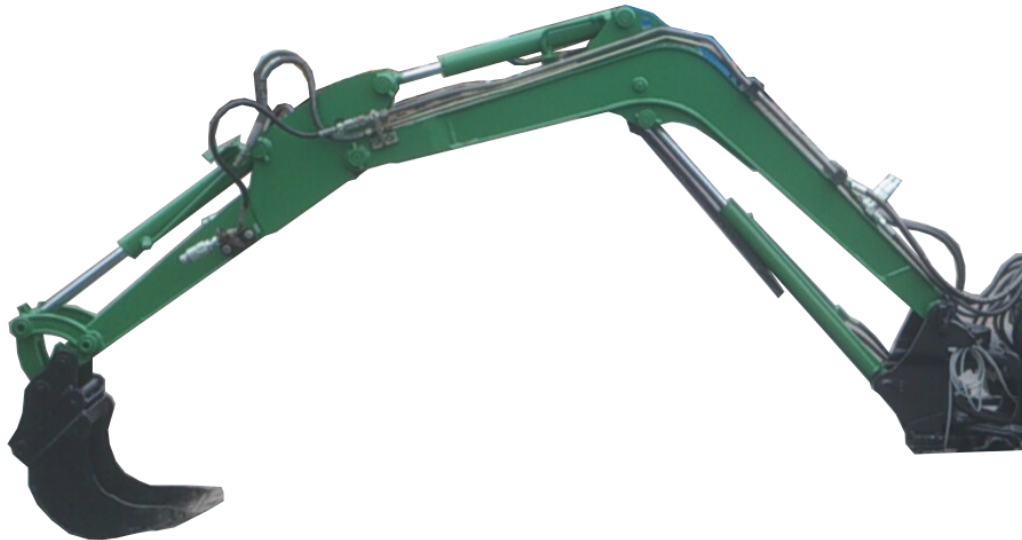
Figur 4.1: Minigrävarens bom och skopa.
