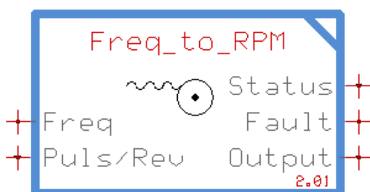
Figur 3.4: Frekvens till RPM, funktionsblock.
